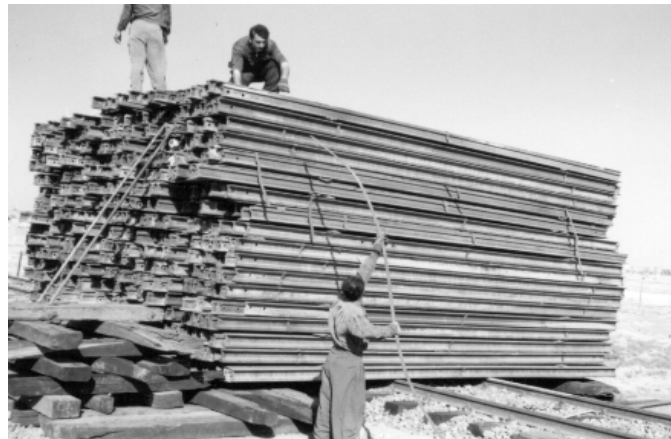
شکل ۶: بارگذاری استاتیک پل بوسیلهٔ وزنه های مخنی ساخته شده از ریل های فرسوده .
