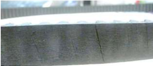
شکل ۳: ترک در پشت تسمه زمانبندی
