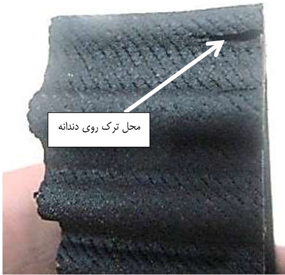
شکل ۲: ترک روی دندان تسمه زمانبندی
