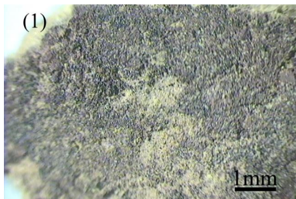
شکل ۹: آزمون کوره رنگدانه قرمز، (۱) قبل از قرارگیری در کوره، (۲) بعد از اعمال حرارت.
