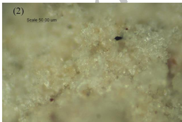
شکل ۶: ویژگی میکروسکوپی از رنگدانه سفید؛ (۱) نور عبوری (۲) نور انعکاسی.
