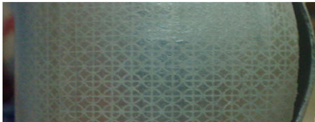
شکل (۱۱): تغییر اندازه دایره‌های حک شده بر روی لوله.
