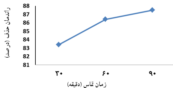
شکل ۶. اثر زمان تماس بر میزان حذف (با غلظت اولیه ۱ میلی گرم در لیتر، مقدار جرم مواد ۱ گرم در لیتر و pH برابر ۶)
