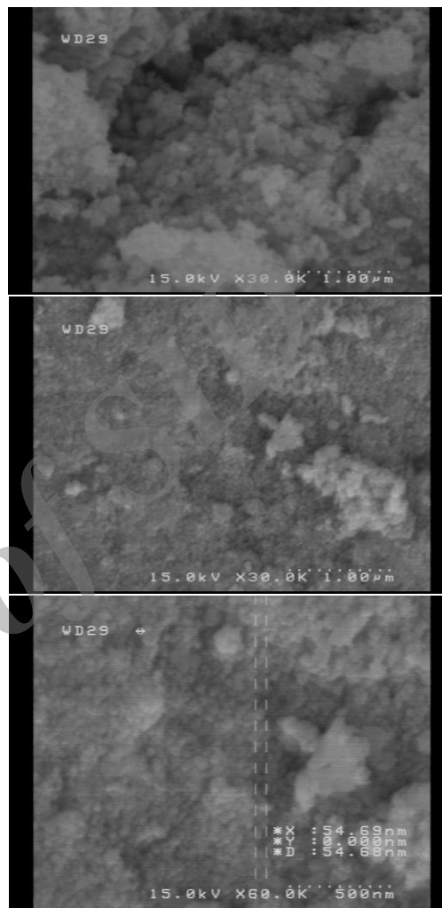
Fig. 6. SEM graph of [P(C_6H_5)_3H]^+[CrF_3I]^-
