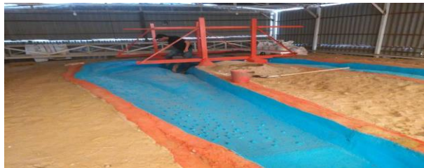
Fig. 2- Jangiye Bend (distorted model)
