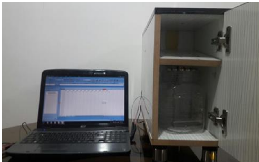
شکل (۲). سامانه ماشین بویایی مورد استفاده
