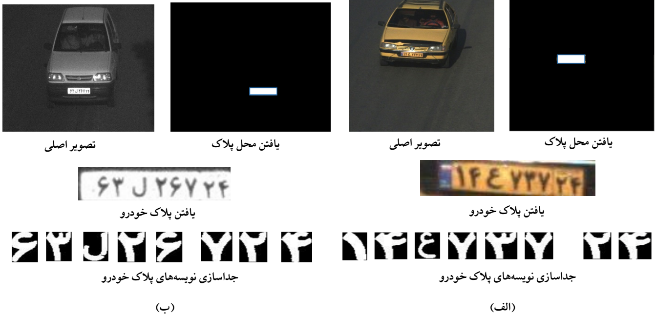
شکل ۴: نتایج اجرای روش استفاده شده برای تشخیص و استخراج نویسه‌های پلاک، روی برخی تصاویر دادگان جمع‌آوری شده (الف): اول و (ب): دوم
