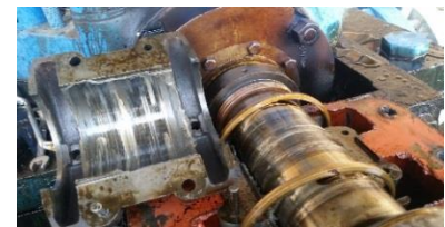
نمونه‌ای از خرابی تکیه‌گاه بر اثر افزایش دما
