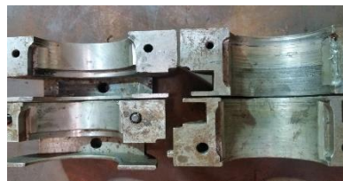
مقایسه دو تکیه‌گاه یاتاقان از نظر سایش سمت راست: تأثیر نانو روان کار سمت چپ: تأثیر روان کار پایه
