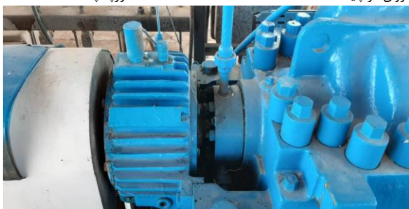
شکل ۲ پمپ مورد استفاده جهت انجام آنالیز عنصری و نمونه‌ای از خرابی‌های ناشی از سایش در تکیه‌گاه‌های یاتاقان آن
