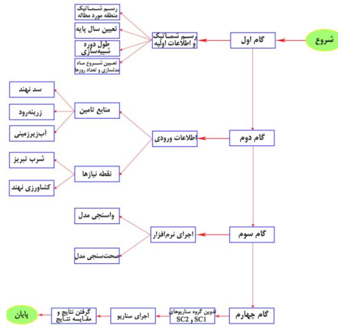
شکل ۷- نمای کلی مدل شبیه‌سازی سد نهند Figure 7- Overview of the simulation model of Nahand Dam
