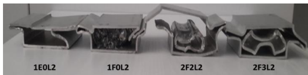
شکل ۱۷: مدل‌های جانبی پس از آزمون ضربه.
