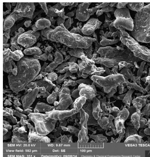
شکل ۱: مورفولوژی پودر Al5083 بدون تقویت‌کننده قبل از آلیاژسازی مکانیکی.
