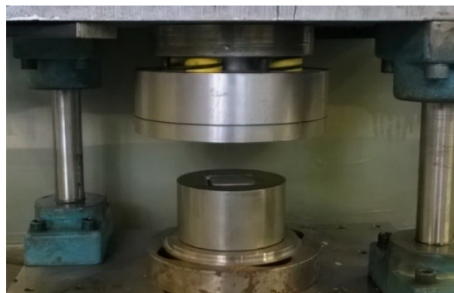
شکل ۴ قالب با ماتریس فلزی برای آزمون تجربی
