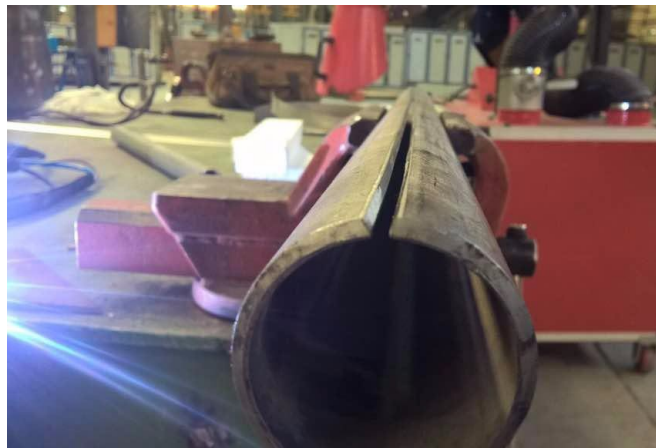
شکل ۲ نوع نمونه قطعه همراه با پخ ۶۰ درجه
