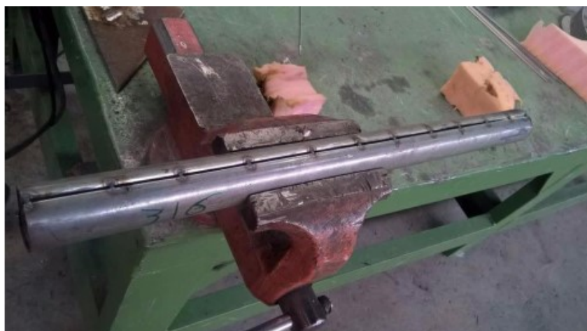
شکل ۱ آماده‌سازی نمونه‌ها جهت انجام عملیات جوشکاری
