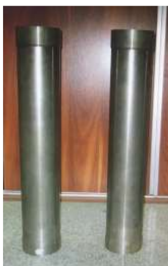
شکل ۵ محصول نهایی پس از عملیات فلوفرمینگ
