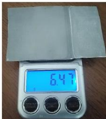
شکل ۹. نمونه‌ای از آند آلومینیوم در حال توزین
