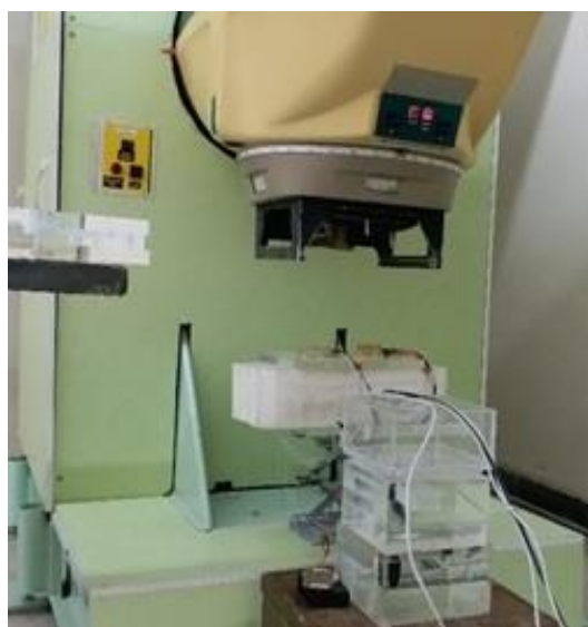
شکل ۶- نمایی از چیدمان آزمون دُز یونیزان
