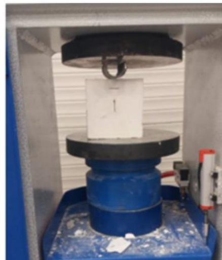
شکل ۳: ماشین تک محوره و نحوه بارگذاری نمونه‌ها
