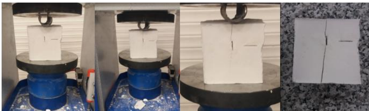
شکل ۶: الگوی شکست درزه ناممتد ۱سانتی‌متری با فاصله ۲سانتی‌متر تا برنده II شکل و زاویه ۹۰ درجه نسبت به افق و درزه ناممتد ۲سانتی‌متری با فاصله ۲سانتی‌متر و عمود بر درزه ناممتد ۱سانتی‌متری و با زاویه صفر درجه نسبت به افق
