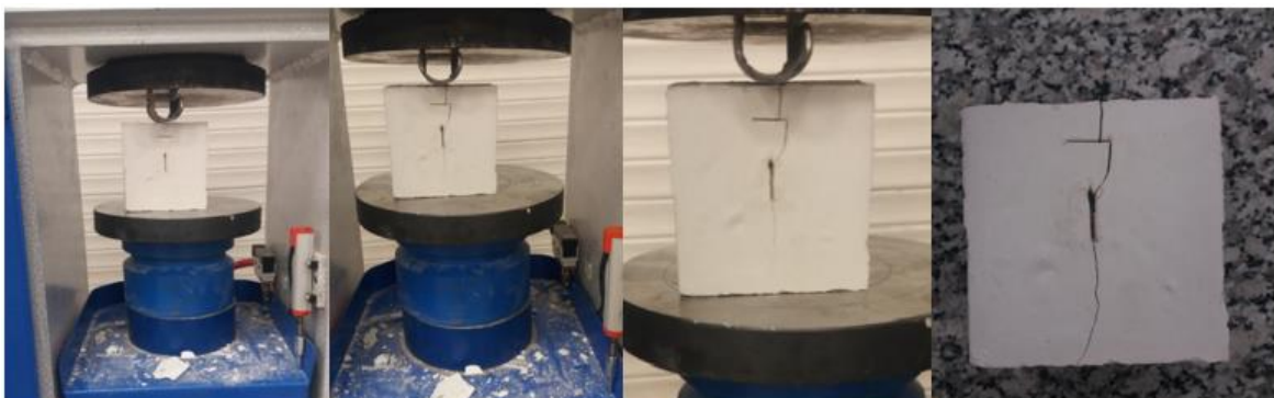
شکل ۴: الگوی شکست درزه ناممتد ۱ سانتی‌متری با فاصله ۲ سانتی‌متر تا برنده II شکل و زاویه صفر درجه نسبت به افق و درزه ناممتد ۲ سانتی‌متری با فاصله ۲ سانتی‌متر و عمود بر درزه ناممتد ۱ سانتی‌متری
