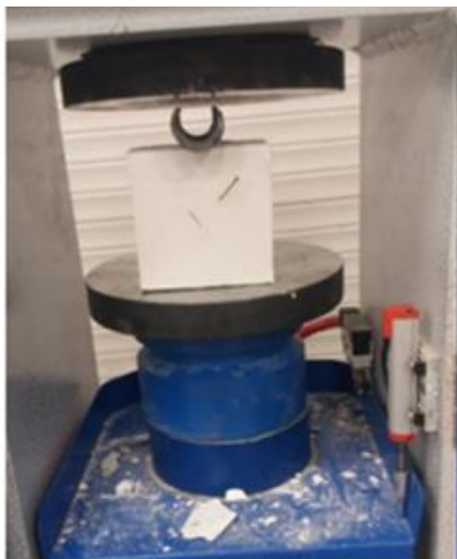
شکل ۳: ماشین تک محوره و نحوه بارگذاری نمونه‌ها
