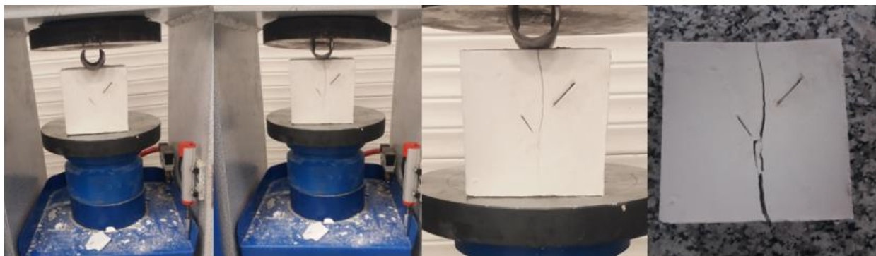
شکل ۷: الگوی شکست درزه ناممتد ۱سانتی‌متری با فاصله ۲سانتی‌متر تا برنده II شکل و زاویه ۵۴ درجه نسبت به افق و درزه ناممتد ۲سانتی‌متری با فاصله ۲سانتی‌متر و عمود بر درزه ناممتد ۱سانتی‌متری و بالای آن
