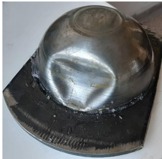
شکل ۲. شکل نهایی نمونه پس از فروریزش
