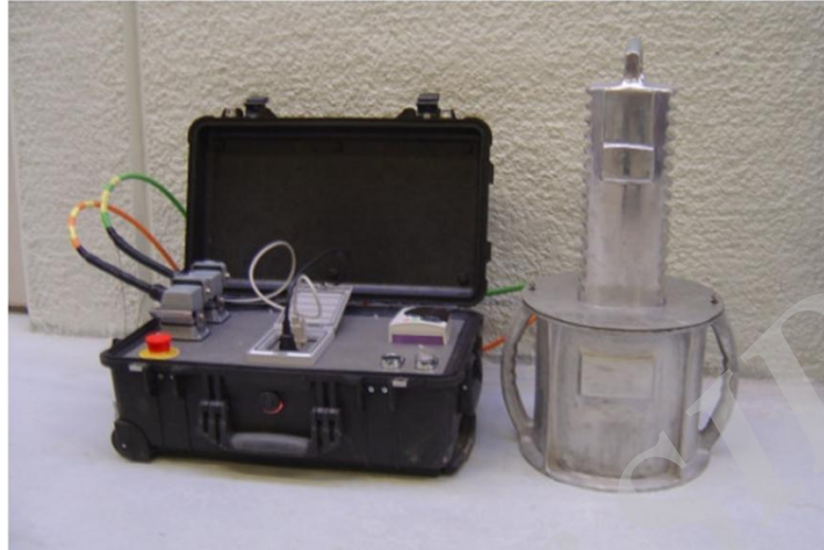
Fig. 2: ConTec 4SCC rheometer.
