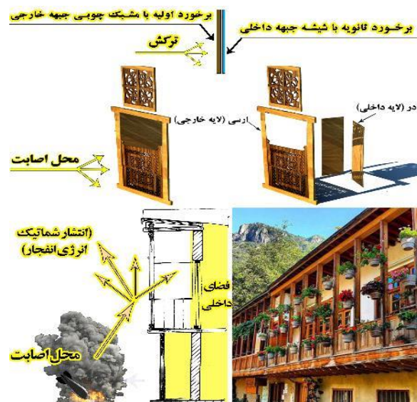
شکل (۱۵): نحوه عملکرد بازشوهای ماسوله در هنگام اصابت و انفجار [۲۱]
