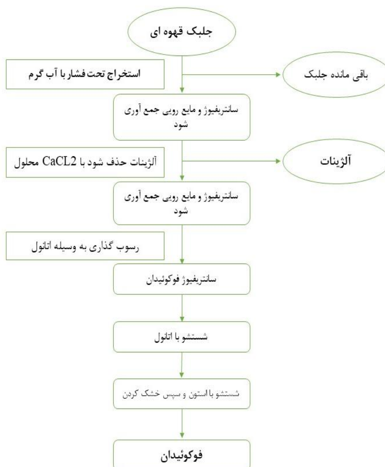
شکل ۲- روش استخراج رایج فوکوئیدان به روش آب گرم (برگرفته از کتاب Seaweed Polysaccharides 2017).
