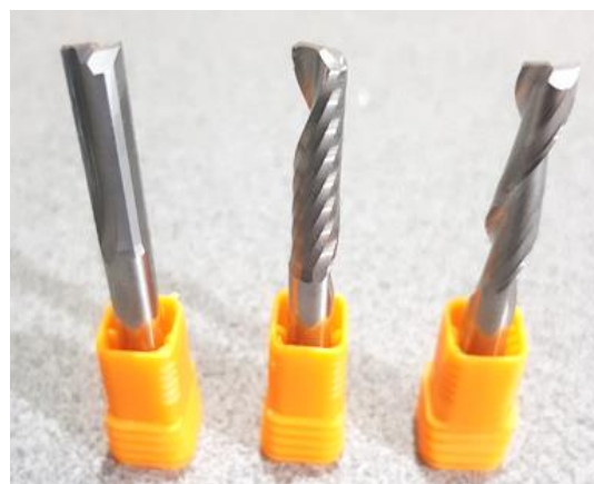
شکل ۷ ابزارهای ۶ میلی‌متر به ترتیب از راست به چپ: دوپر مارپیچ، تک پر مارپیچ، دو پر مستقیم
