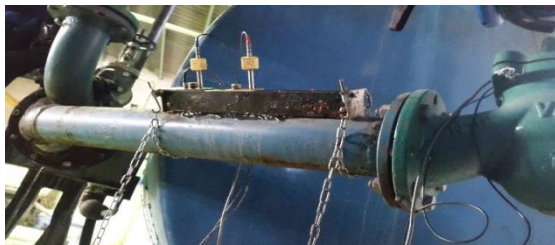
شکل ۲- سامانه اندازه‌گیری دی‌آب ورودی و خروجی هر تجهیز
