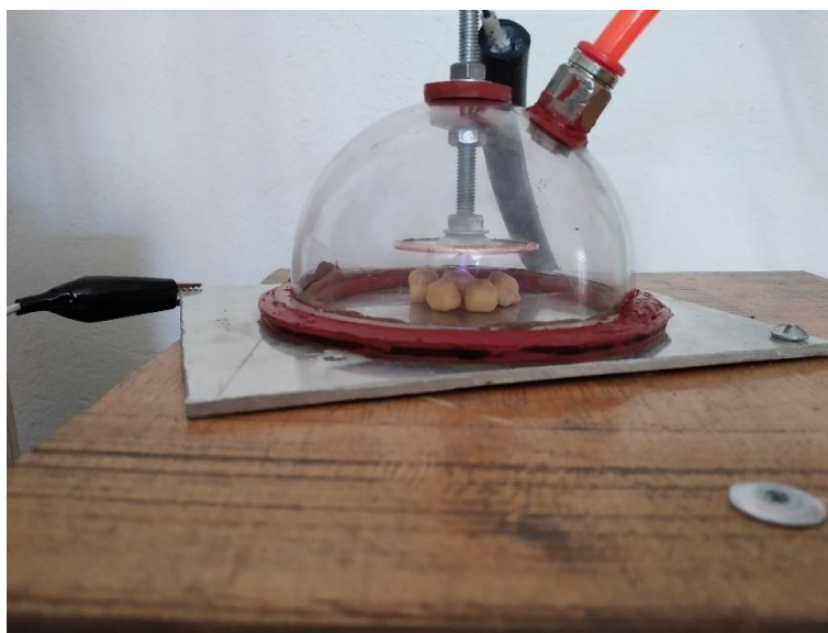
شکل ۱- تصویر سامانه پلاسمای سرد بر اساس تخلیه کرونا
