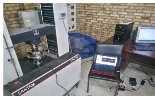
شکل ۴- الف) نحوه باردهی به نیروسنج در دستگاه آزمون کشش- فشار و ب) نمودار کالیبراسیون نیروسنج
