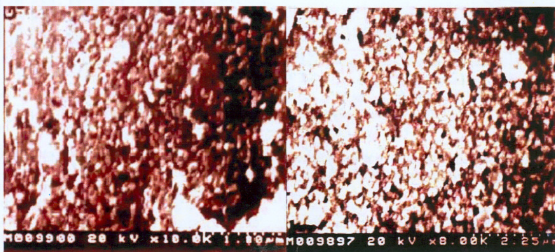
Fig. 4: SEM micrograph of TiO 2
