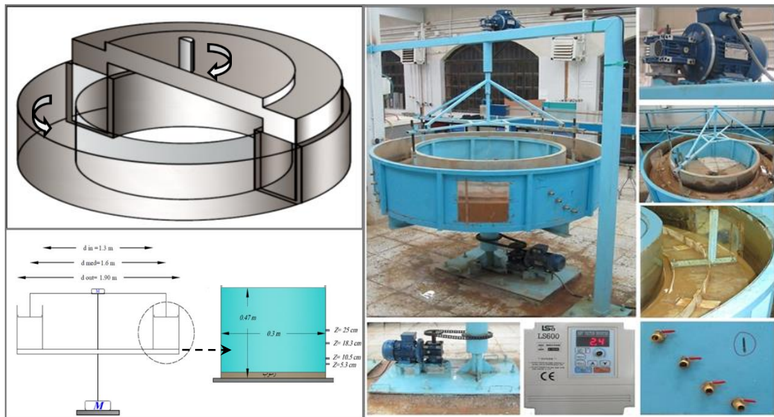
Fig. 2- The Annular Rotating Flume شکل ۲- نمایی از اجزای فلوم دایره‌ای مورد استفاده
