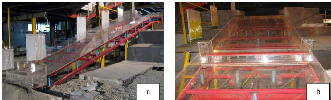
Fig. 2- (a) Laboratory model of Darian dam's spillway, (b) Aeration System شکل ۲- نمایی از (a): مدل سرریز تنداب سد داریان. (b): سیستم هواده
