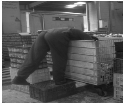
شکل ۳: وضعیت نامناسب اپراتور سبد اتوکلاو
