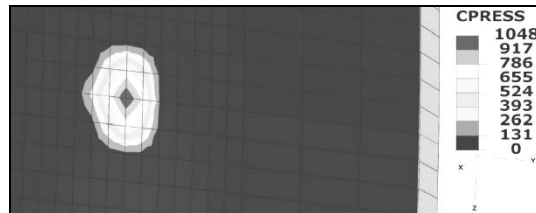
شکل (۹) - بیضی هرتز و تنش عمودی فشاری چرخ در محل تماس آن با ریل
