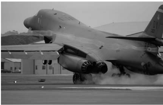
شکل ۵. هواپیمای راکول بی. وان. بی با بال‌هایی با قابلیت جابه‌جایی
