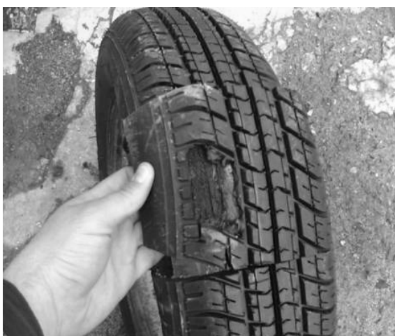
شکل (۳) تایر رادیال خرابی تایر در اثر افزایش تولید حرارت در منطقه شاننه تایر
