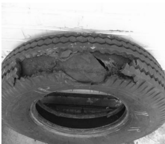
شکل (۲) تایر بایاس خرابی تایر در اثر افزایش تولید حرارت در منطقه شاننه تایر
