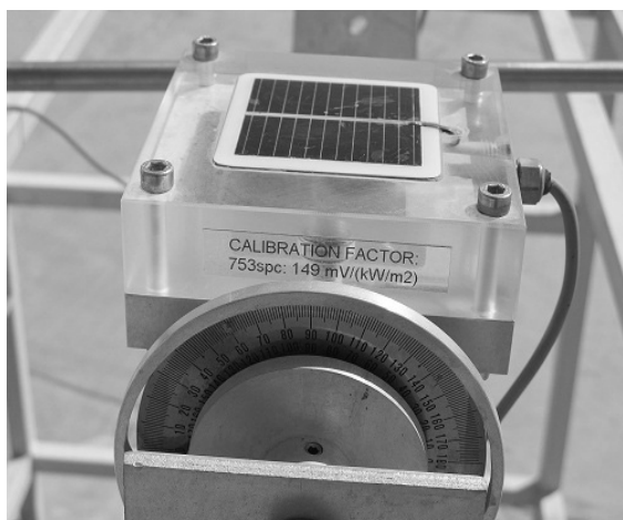
شکل ۱. تشعشع سنج برای اندازه‌گیری تابش کل
