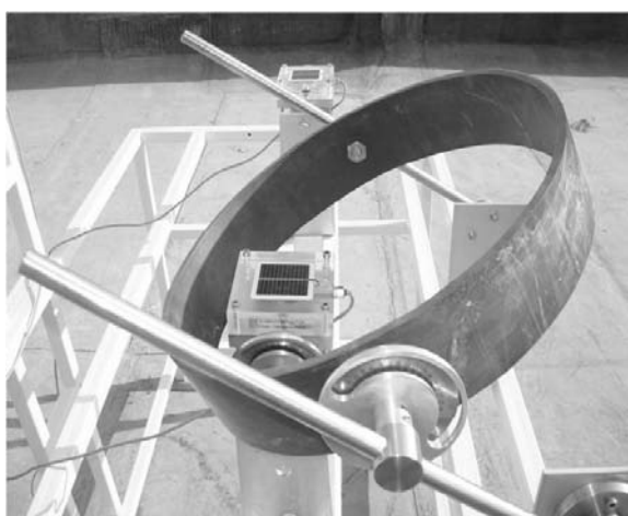
شکل ۲. تشعشع سنج برای اندازه‌گیری تابش پراکنده
