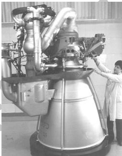
شکل ۲- موتور موشک RD-253 [۷].
