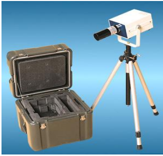
تصویر ۳- دستگاه رادیوگرافی قابل حمل نیز در بسیاری از موارد مورد استفاده قرار می‌گیرد
