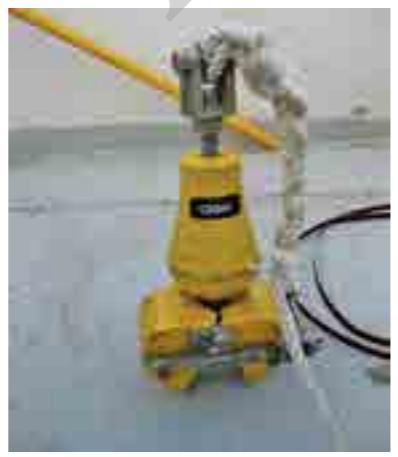
شکل ۲- نمونه‌گیر گرب مخصوص برداشت رسوب بستر
