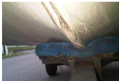
شکل ۲- چکه کردن رزین الیاف ( Leching )
