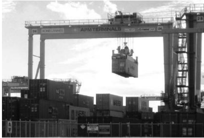
شکل ۳-۸) جرثقیل پشته سازی اتوماتیک
