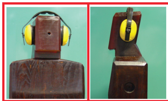
تصویر ۲: نمای آداپتور ساخته‌شده و چگونگی قرار گرفتن حفاظ رو گوشی روی سر
