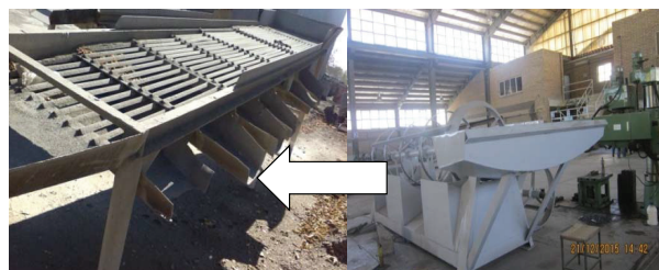
تصویر ۵: گلوله سورت‌کن قبل و بعد از مداخله
