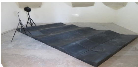
شکل ۲: چینش پانل سوراخ‌دار در اتاق بازآوا؛ جانمایی میکروفون و بلندگوی صوتی
