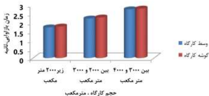
شکل ۶. مقایسه زمان بازآوایی اندازه‌گیری شده در مرکز و گوشه کارگاه‌ها
