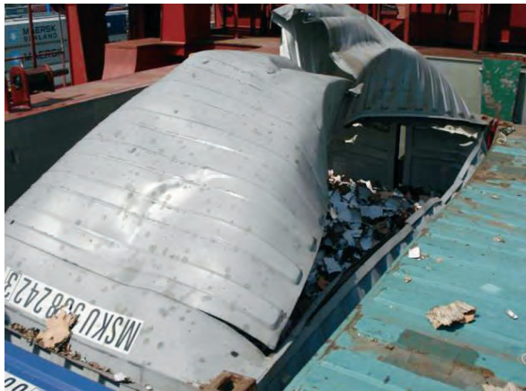
تصویر (۴): ترکیدن کانتینر محتوی فسفید آلومینیوم در اثر حریق در انبار کشتی Maersk Kinloss
