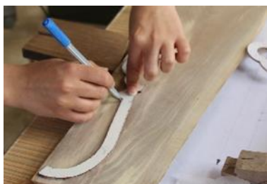
تصویر ۹- انتقال الگو بر روی چوب
