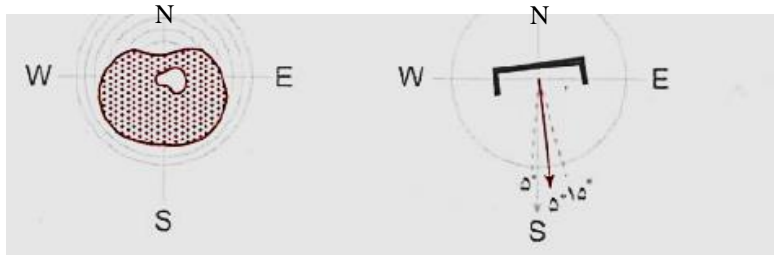
تصویر شماره ۲۵: جهت استقرار ساختمان با توجه به اقلیم گرم و مرطوب (منبع: کسمایی، ۱۳۸۴: ۱۲۷)
