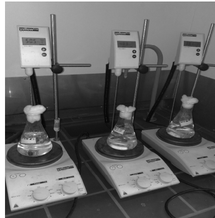
شکل ۱- مجموعه اجاق (گرم‌کن)، ارلن، لوبیا، همزن مغناطیسی و محلول اسمزی
