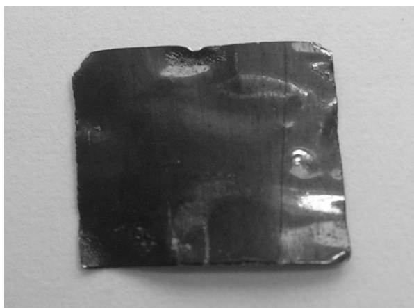
شکل ۳- تصویر ورق طلا پوشیده شده با نانولوله‌های کربنی تک جداره
