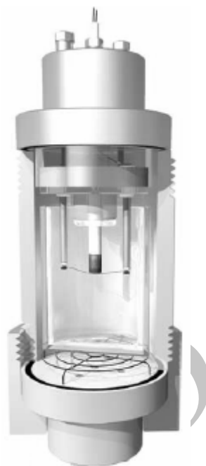
شکل ۶- تصویر محفظه احتراق (بمب NFWB) شامل مخزن، نگهدارنده نمونه، نمونه و سیم (نیکل- کروم) جهت اشتعال [۸]
